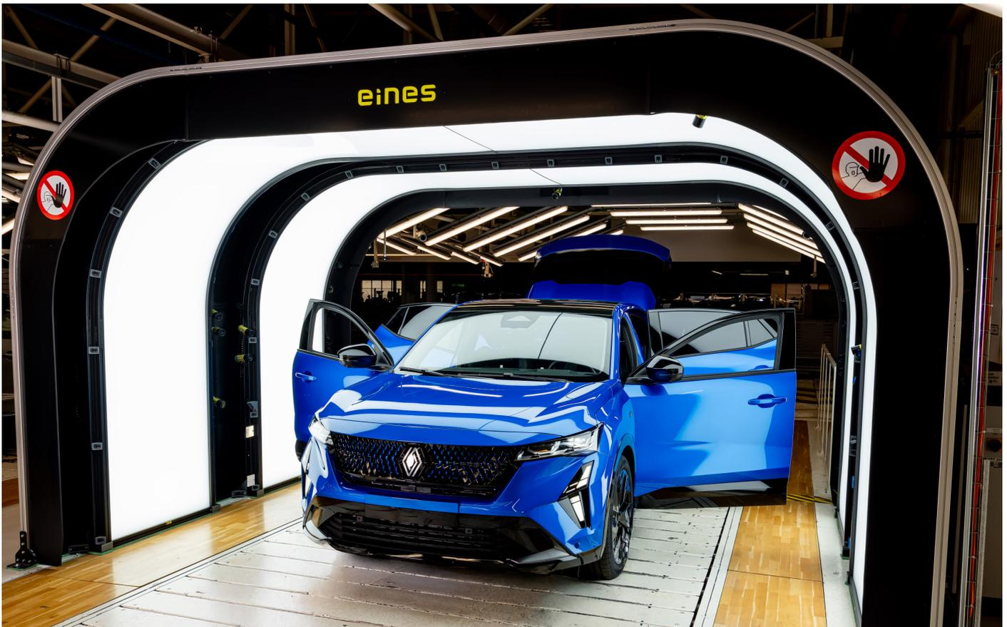
Túnel para control de calidad en ensamblaje final en la Factoría de Renault Group en Palencia
