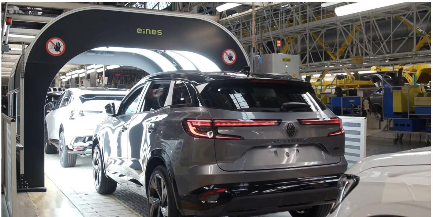
Túnel para control de calidad en ensamblaje final en la Factoría de Renault Group en Palencia
